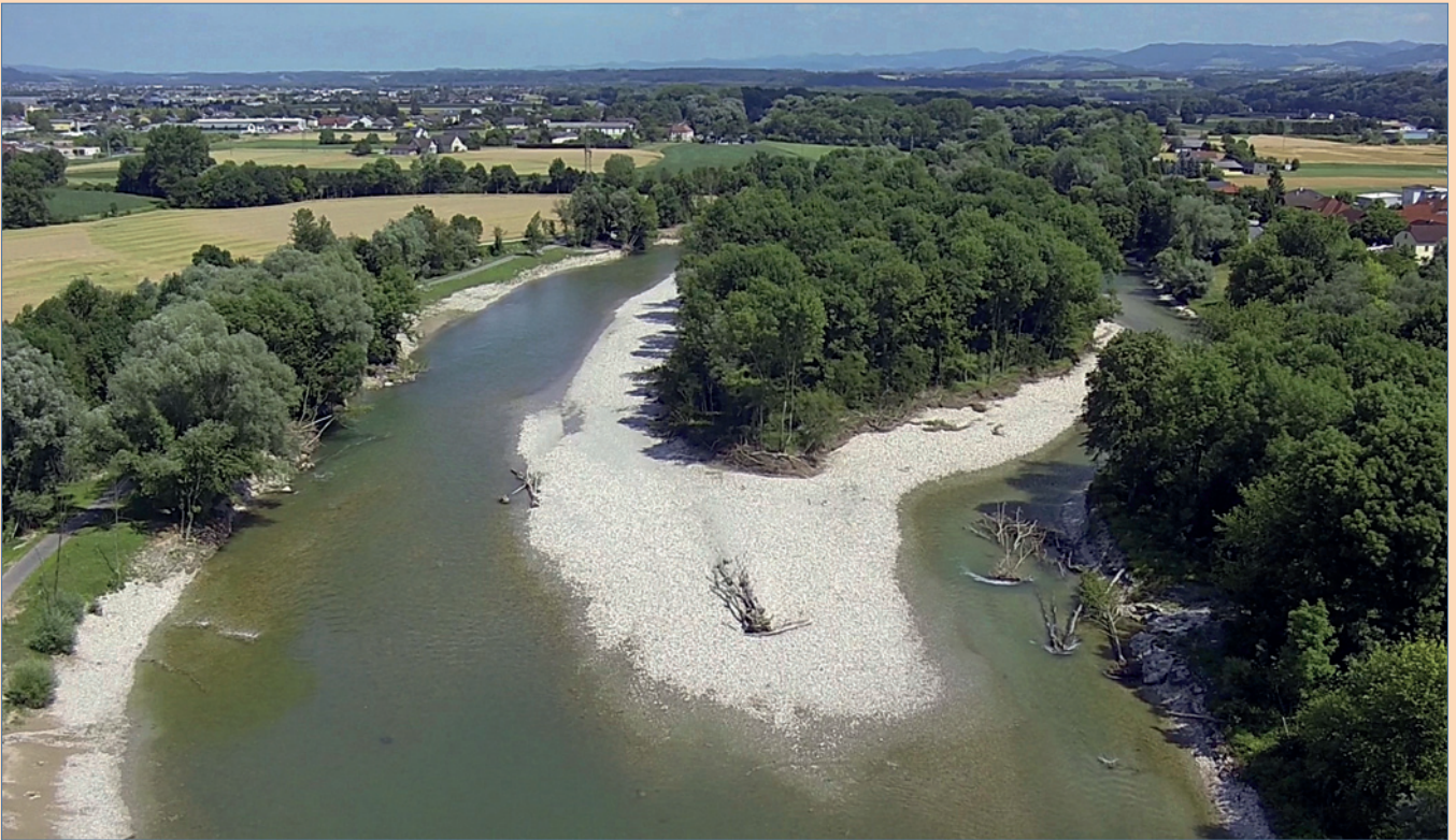
▲ Abb. 8: Erfolgreiche Gewässerrevitalisierung am Beispiel einer Aufweitung der zuvor monoton regulierten Ybbs bei Amstetten. Foto: extremfotos.com
